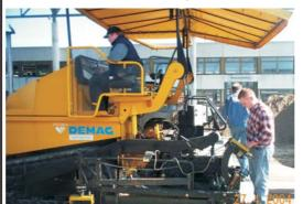
der Arbeitsvorbereitung die Bedienung des Fertigers, die Einstellung der Einbaubohle und der fachgerechte Walzeneinsatz. Jeder Auszubildende arbeitete im Wechsel in den einzelnen Arbeitsbereichen einer Asphalt-Einbaukolonne! Der vorbildliche Einsatzeifer der Auszubildenden bestätigte dieses Schulungskonzept. Die zukünftigen Schulungen werden um die Bedienung einer Asphalt-Fräse und dem anschließenden Heißeinbau ergänzt.
