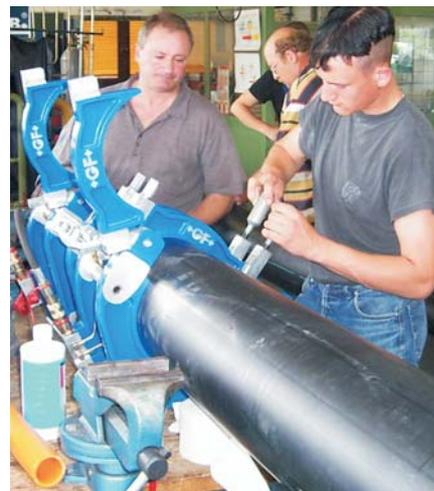
**schweißung** gehört das korrekte abschälen der Oxydschicht vom PE-Rohr (Foto li. unten). (Gre/Si)
