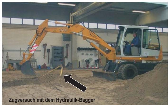
Zugversuch mit dem Hydraulik-Bagger
