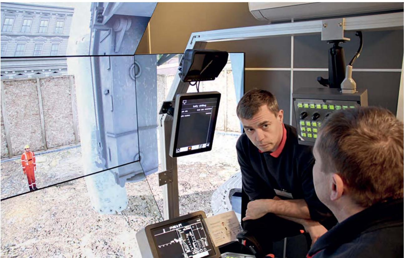
Einweisung am Simulator für Großdrehbohrgeräte.
