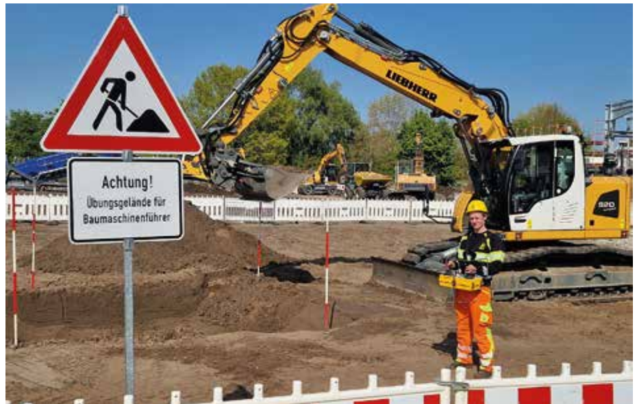
Maschinenbedienung auf Sicht: Per Funkfernbedienung lässt sich die Maschine in unmittelbarer Nähe, jedoch außerhalb des Gefahrenbereichs, bedienen.
